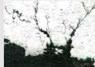
Esempio di corrosione sotto tensione trans-cristallina dell'acciaio inossidabile 1.4401 con alta concentrazione di cloruri.
