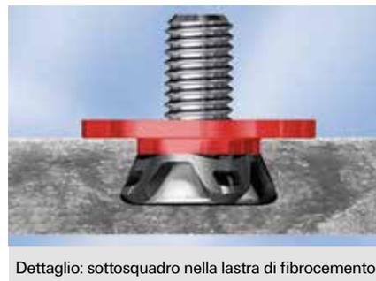
Dettaglio: sottosquadro nella lastra di fibrocemento
