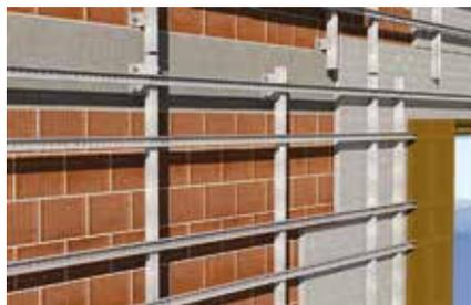
Sottostruttura montanti e traversi
