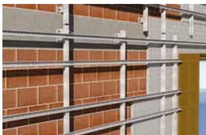
Sottostruttura montanti e traversi
