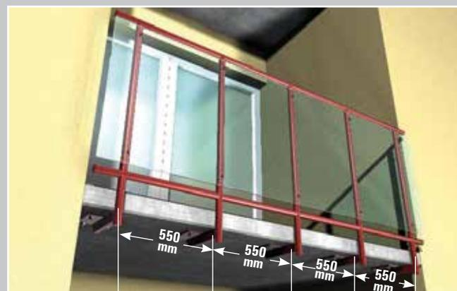
Non è possibile utilizzare ancoranti M10 a causa dello spessore ridotto del supporto in calcestruzzo. Tuttavia, possono essere utilizzati ancoranti M8, insieme a non meno di **5 piastre/perni di ancoraggio e 20 ancoraggi 8/10 A4.**
