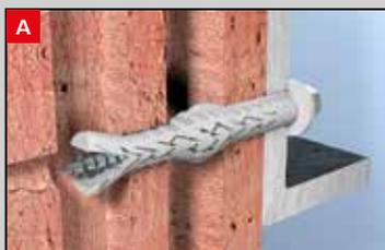
**A** Su materiale forato la doppia espansione genera forze di ancoraggio che non inducono tensione nel supporto e si distribuiscono uniformemente all'interno del foro (su supporti semipieni, forare solo a rotazione senza rotoperussione).
