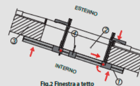
Fig.2 Finestra a tetto
